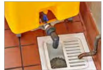
O tubo de drenagem manobrável pode ser posicionado em qualquer direção, conforme necessário. Use com ou sem mangueira de drenagem com base no acesso disponível ao escoamento no piso.
