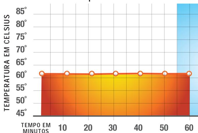
Para uma retenção ideal da temperatura, aqueça o prato para alimentos a +90°-100°C antes de enchê-lo com comida quente a uma temperatura de cerca de 85°C.
